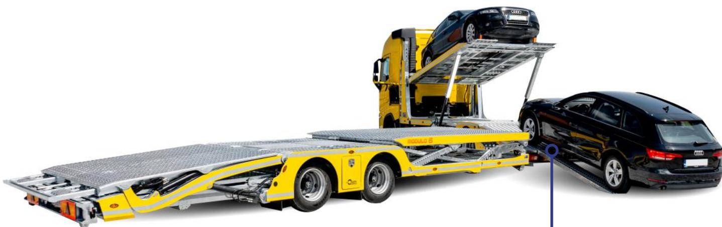
Beim Modulo 6 mit optionalem, absenkbarem Heck und zusätzlichen Auffahrschienen muss der Anhänger zum Beladen des Motorwagens nicht abgekoppelt werden und ein Soloeinsatz ist möglich.
