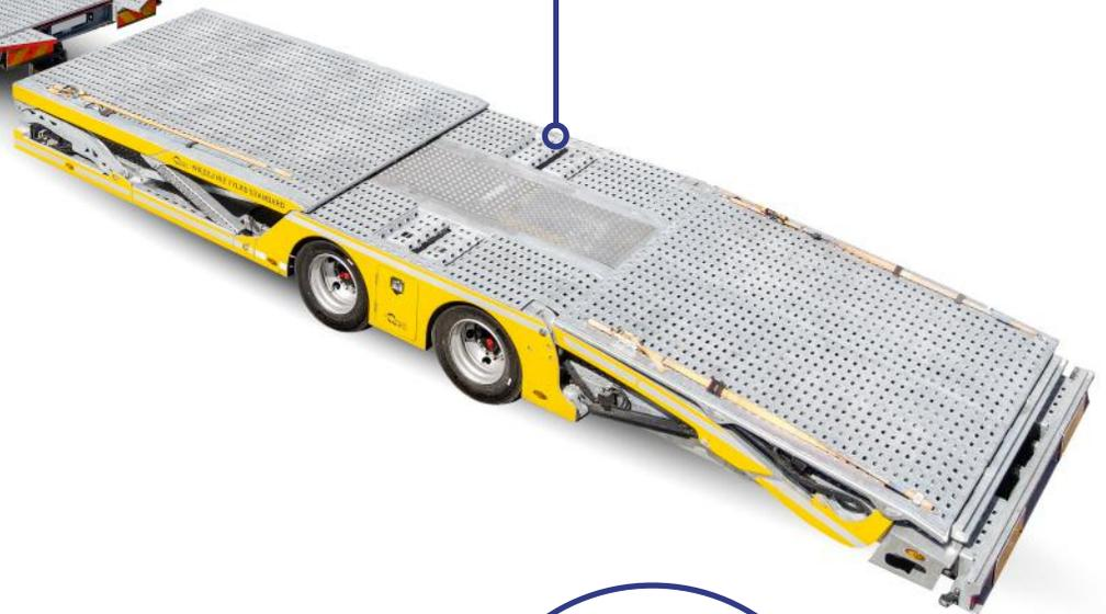
Obere Hubdecks werden mit Hubzylindern hydraulisch angehoben.
