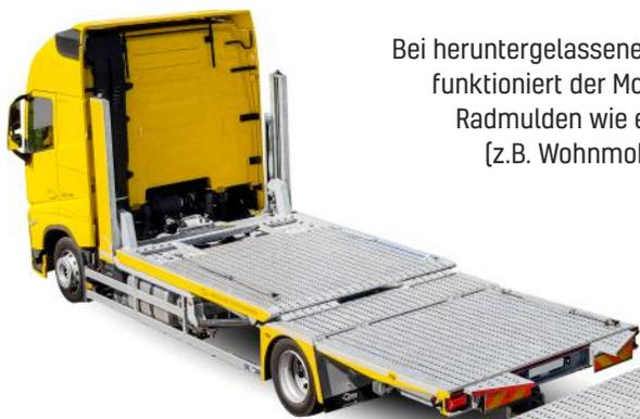
Bei heruntergelassenen Hubdecks funktioniert der Modulo 6 dank Radmulden wie ein Flachzug (z.B. Wohnmobiltransport)
